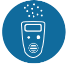
Gassignaleringsapparatuur met akoestisch en optisch signaal
