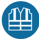
Bij werkzaamheden langs de weg: reflecterende kleding
