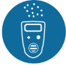
Gassignaleringsapparatuur met akoestisch en optisch signaal
