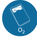
Bij werkzaamheden in een afgesloten ruimte: zuurstofmeter
