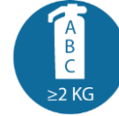
Bij werkzaamheden aan meteropstellingen: brandblusser (klasse A/B/C) van minimaal 2 kg
