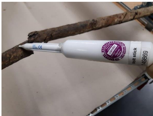
onjuiste locatie voor meten met voltestick
