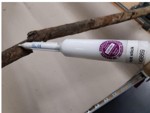
onjuiste locatie voor meten met voltestick
