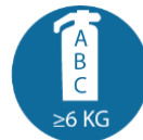
Bij werkzaamheden aan aansluitleidingen: brandblusser (klasse A/B/C) van minimaal 6 kg
