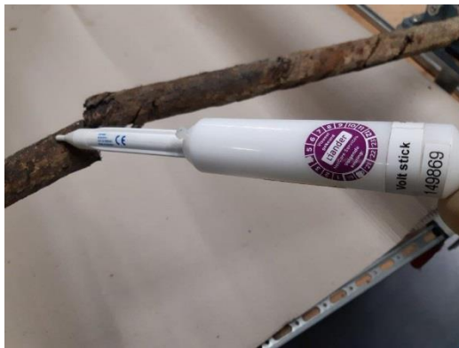
onjuiste locatie voor meten met voltestick
